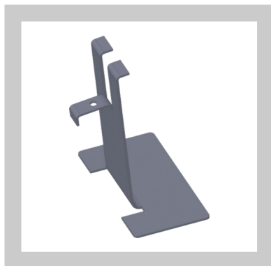
Abb. 27 Detail der Federlasche
