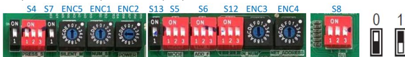
Fig. 29: Micro-interrupteurs sur la carte principale de l'unité extérieure
