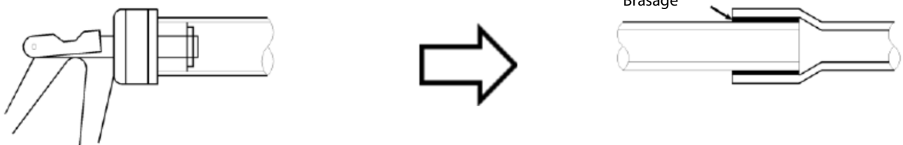
Fig. 15: Expansion de tubes pour le brasage
