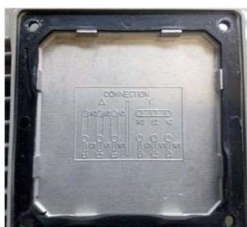
Víčko svorkovnice s nákresem zapojení vinutí motoru
