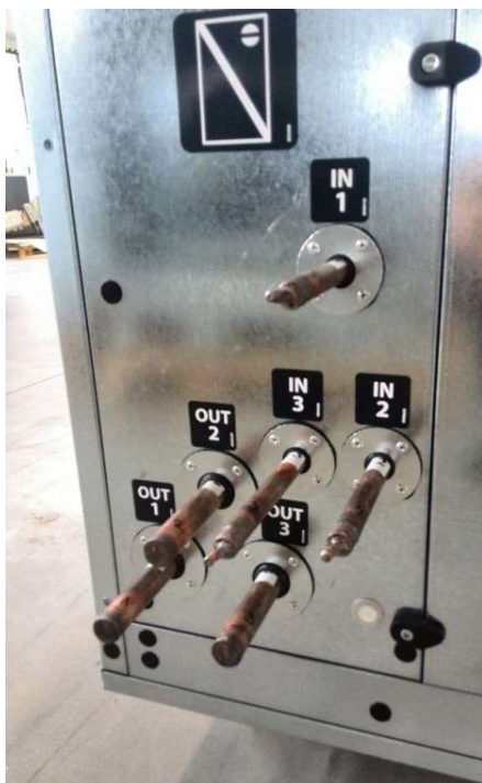
Příklad značení 3-okruhového výparníku.
