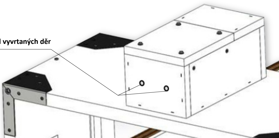
Příklad umístění otvorů ve stěně ochranné skříňe, bez předem vyrobené drážky
