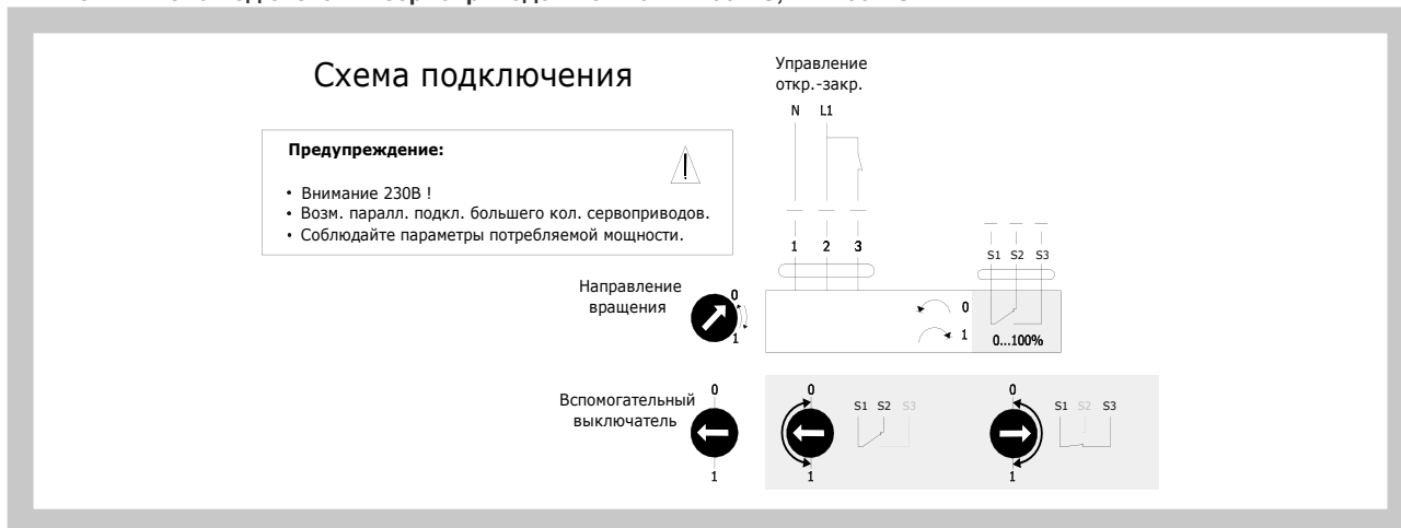
Рис. 13 Схема подключения сервоприводов Belimo LM 24A, NM 24A
