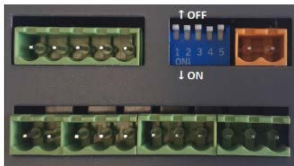
Obr. 24: Přepínače DIP pro nastavení parametrů komunikace na vnitřní jednotce
