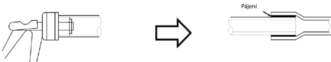
Obr. 14: Rozhrdlení trubek pro pájení
