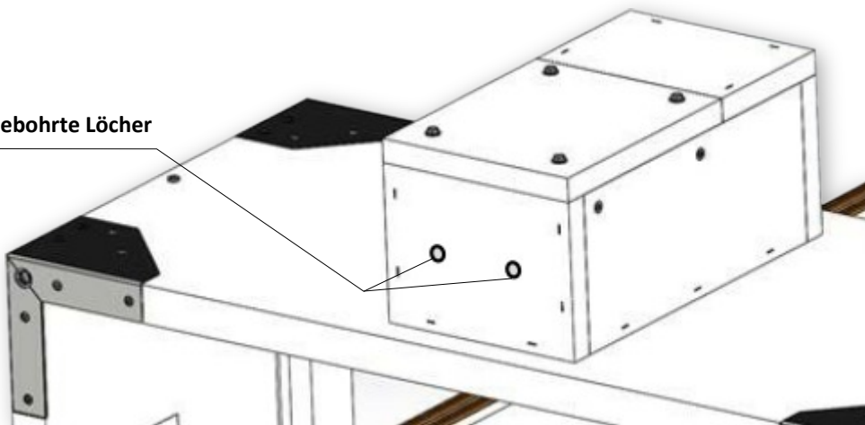
Beispiel für die Anbringung eines Lochs in der Wand eines Schutzgehäuses, ohne vorgefertigte Nut
