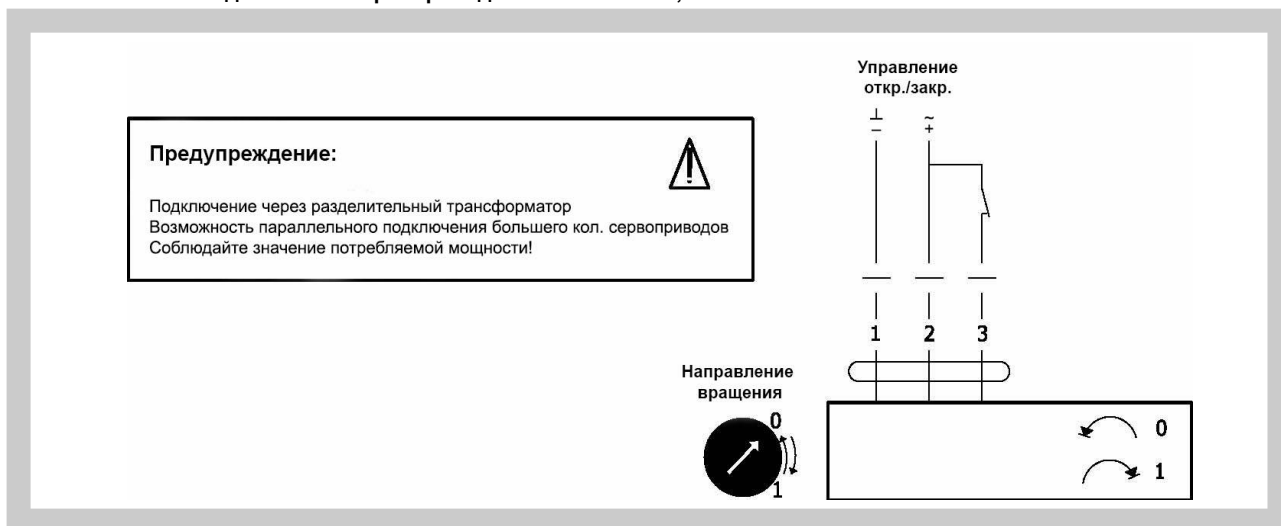
Рис. 9 Схема подключения сервоприводов Belimo LM 24A, NM 24A и SM 24A
