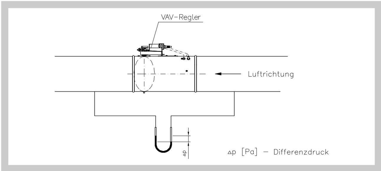
Abb. 4 Rohrdruckregelung
