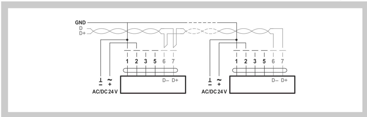
Abb. 11 Kompaktregler LMV-D3-KNX, NMV-D3-KNX
